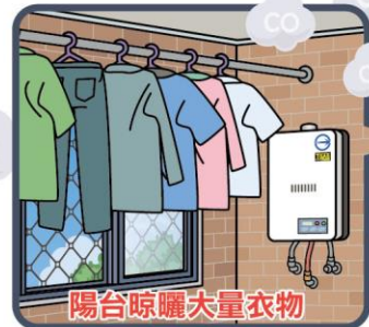
屋外式瓦斯熱水器 安裝在室內
