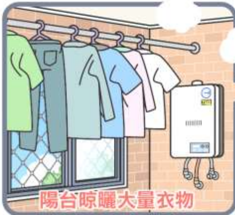
屋外式瓦斯熱水器 安裝在室內
